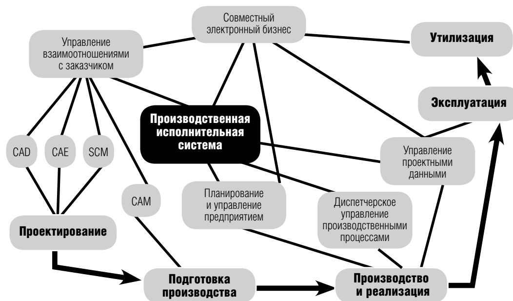
Рис. 1. Системы автоматизации этапов жизненного цикла изделий РЭС.
