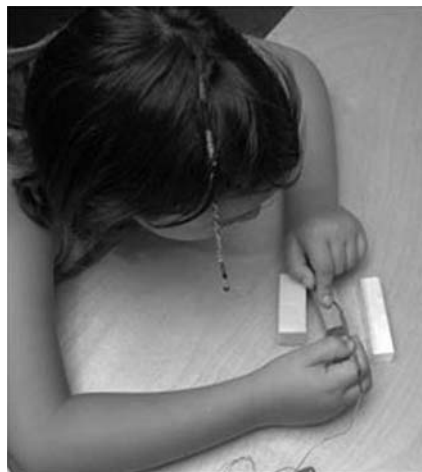
Рис 3а. Школьница измеряет температуру пальца, который находится в контакте с пенопластом, куском дерева или алюминия. Все объекты находятся при комнатной температуре 24° Цельсия.
